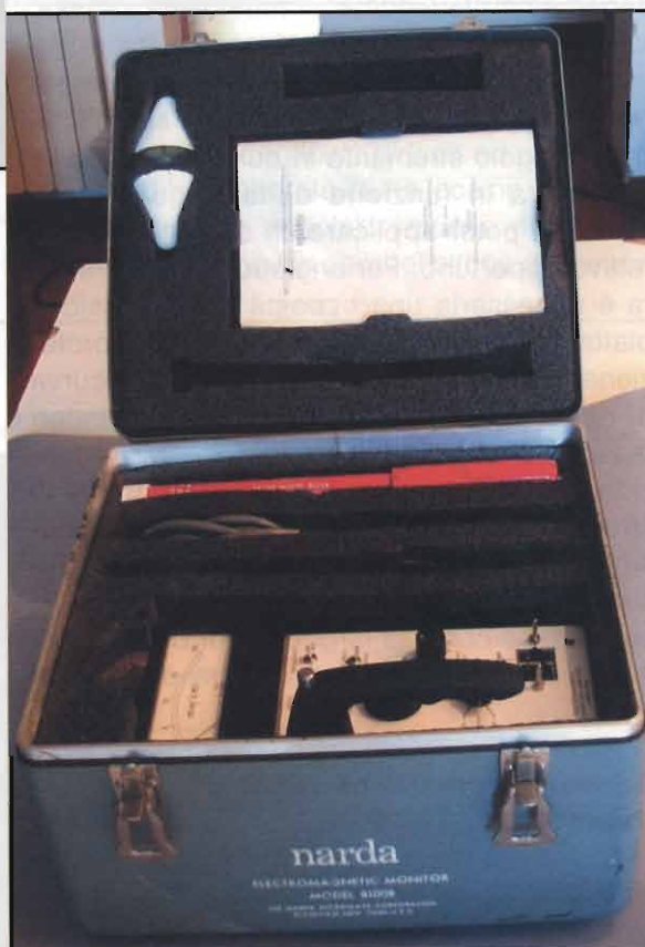
figura 2 - Corredo per la misura di intensità di campo elettrico e di "perdite" a radiofrequenza da linee di trasmissione e forni a microonde. Nella valigia alloggiato l'indicatore, una serie di sonde a banda larga e stretta, alcuni radomi (in alto a sx) che fungono da distanziali per la ricerca di perdite RF, i cavi e i manuali.
